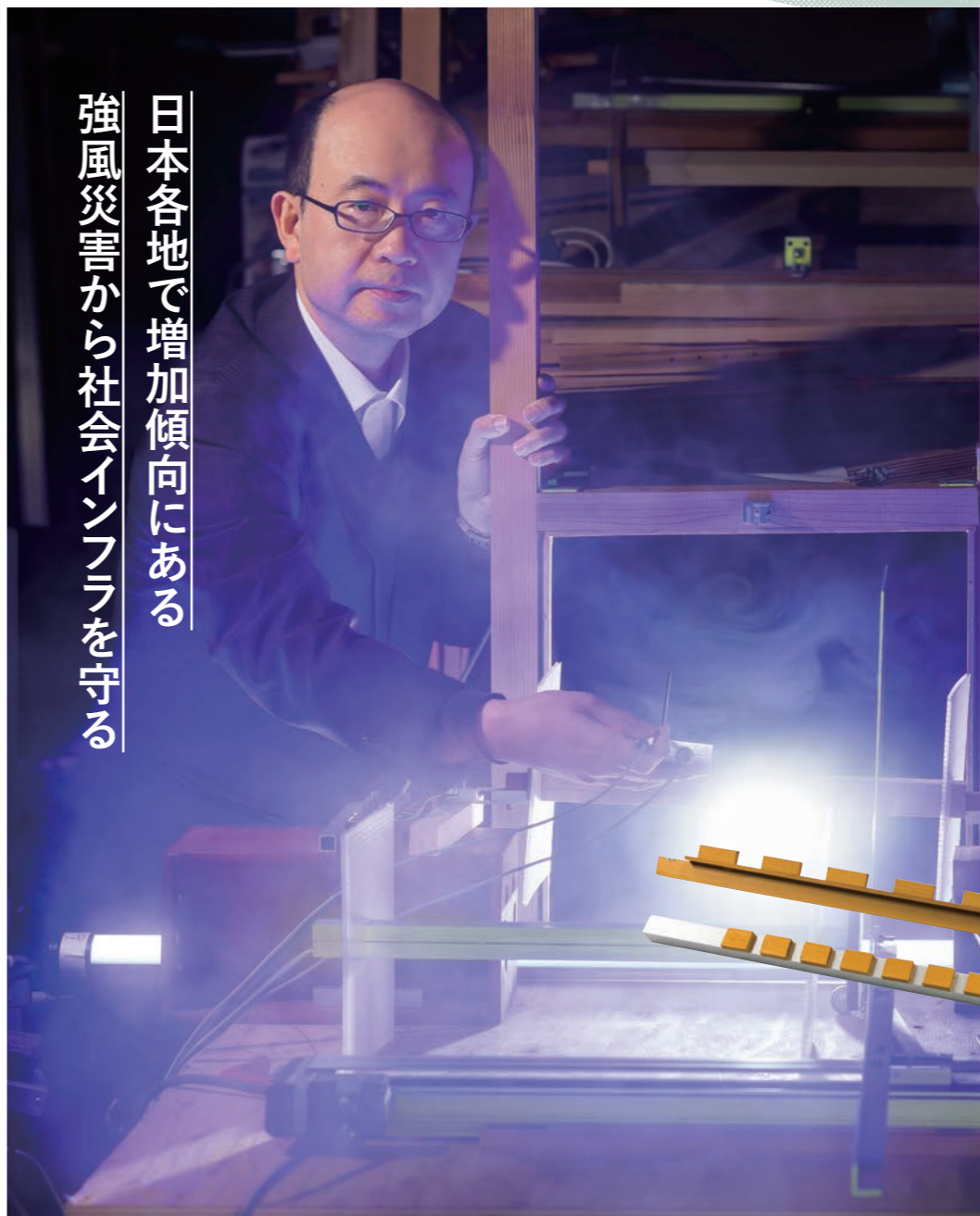
風洞実験に用いる橋を模した木製の模型
